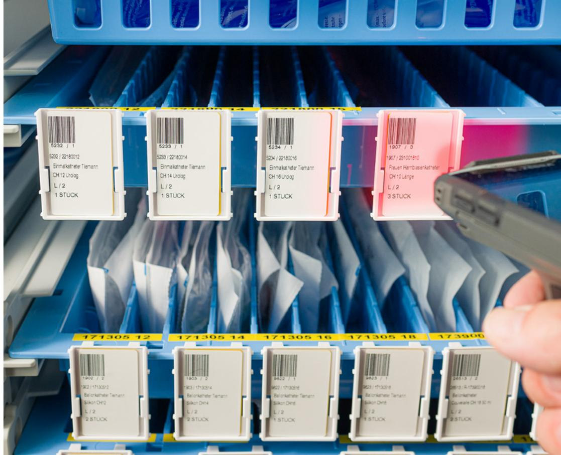
Abbildung 4: Kanban-System: Barcode-scannen bei der Bestellaufnahme
